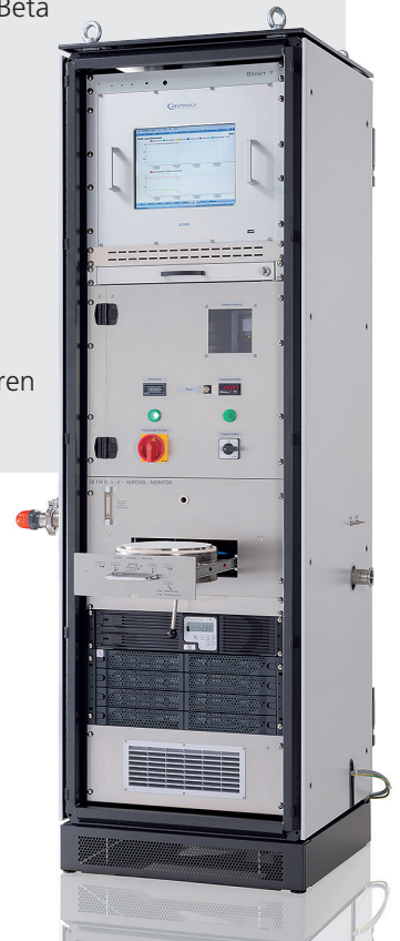
Abbildung 1: LB 150 D-R Alpha-Beta Festfilter-Monitor mit geöffneter Schublade der Partikelsammeleinheit.
